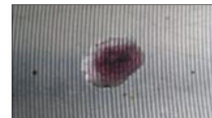
Afbeelding 2: De roodkleuring door de aanwezigheid van molybdeen in 316 is duidelijk waarneembaar.
